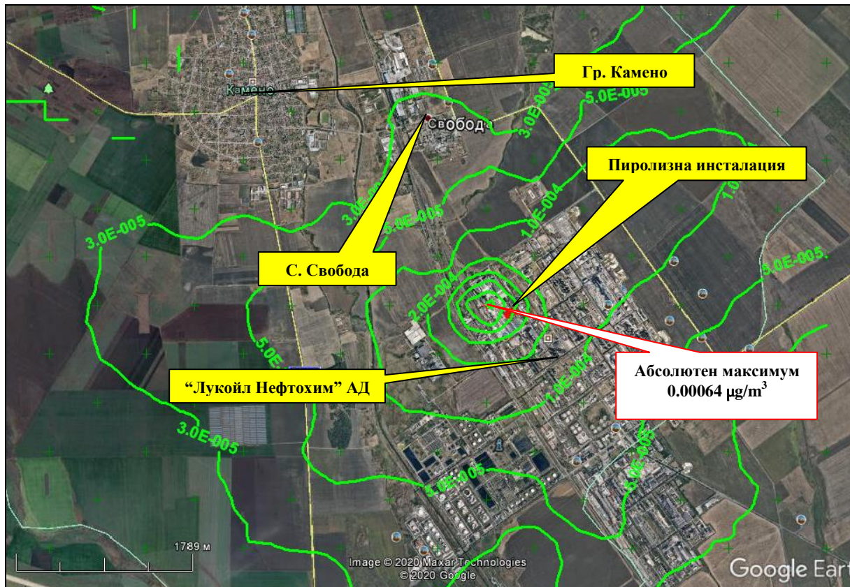
Фиг.27. Разпределение на сумарните СГ приземни концентрации на (Sb), (As), (Pb), (Cr), (Co), (Cu), (Mn) и (Ni), (V), генерирани от ИУ на пиролизната инсталация (модел AERMOD).
